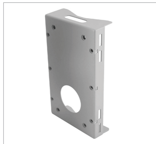
СТОЛБОВОЙ УЗКИЙ ПРЯМОЙ КРОНШТЕЙН 232x136x60 мм (9.1x5.4x2.4 дюймов); Диаметр: 112-140 мм (4.4-5.5 дюймов); 0.7 кг (1.6 фунтов); Поставляется с хомутом из нержавеющей стали-4, М8*16 винт-4, шайба-4.
